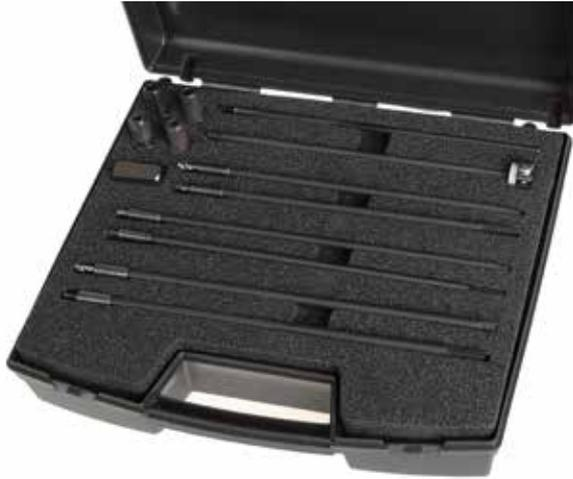
**Juego de herramientas para la extracción del electrodo de las bujías de pre-calentamiento**
